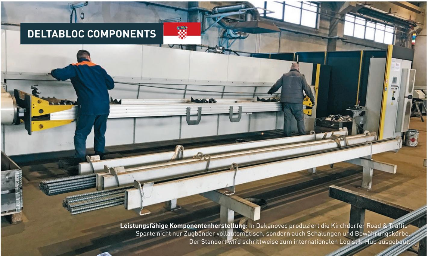
**Leistungsfähige Komponentenerstellung:** In Dekanovec produziert die Kirchdorfer Road & Traffic-Sparte nicht nur Zugbänder vollautomatisch, sondern auch Schalungen und Bewehrungskörbe. Der Standort wird schrittweise zum internationalen Logistik-Hub ausgebaut.
