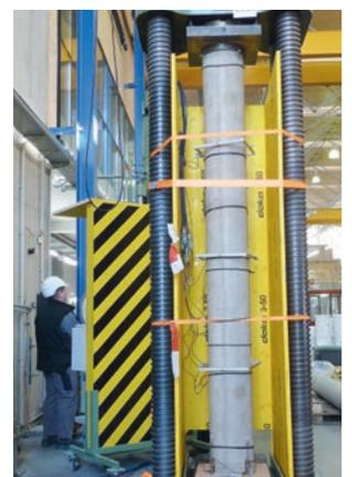
Anhand von drei völlig neuartigen Versuchskörpern wurden die Ansätze aus der Grundlagenforschung erfolgreich demonstriert: (v.l.) Ein I-Träger mit eingebrachten Stahllitzen, ein Brückenhohlkörper mit Ortbetonergänzung sowie eine Rotop-Stütze mit UHPC Kern in einer nur 5 cm starken, bewehrten Schale haben die gestellten Erwartungen deutlich übertroffen.
