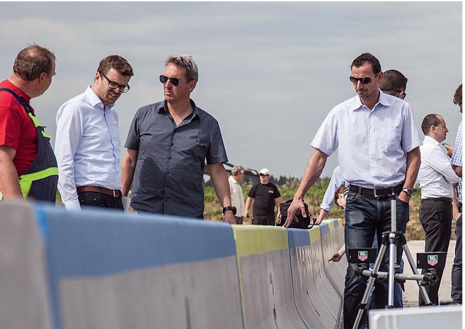
Thomas Edl (2. v.l.) inspiziert die zum Anprallversuch aufgestellten „ZERO DEBRIS CONCRETE“-Elemente, bevor ein 13 Tonnen-Bus das System auf Herz und Nieren testet.
