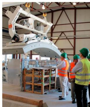
... während die hochkomplexen, ca. **7 Tonnen schweren Betonteile** an einem Vakuum-Sauger im Minutentakt durch die hochmoderne Produktionshalle schweben.
