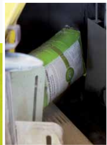
Der Sack wird auf einen der acht Füllstützen geschossen ...
