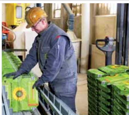
Gerald Kaltenböck lädt den Rotorpacker mit leeren Papiersäcken.
